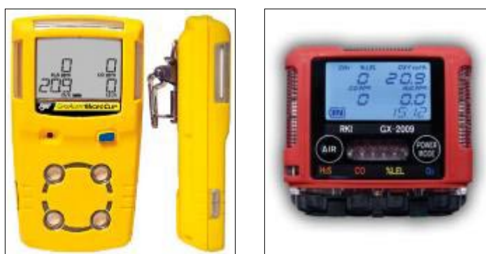
Exposímetros para la medición de gases nocivos
