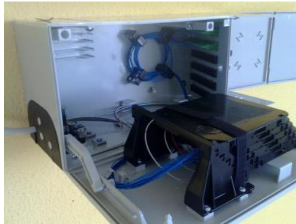
Imagen 3.7. Detalle Splitter CTO interior
